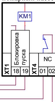
На рис. слева показан пример взаимной блокировки двух шкафов управления основным и резервным пожарными насосами для исключения одновременной работы обоих насосов.
